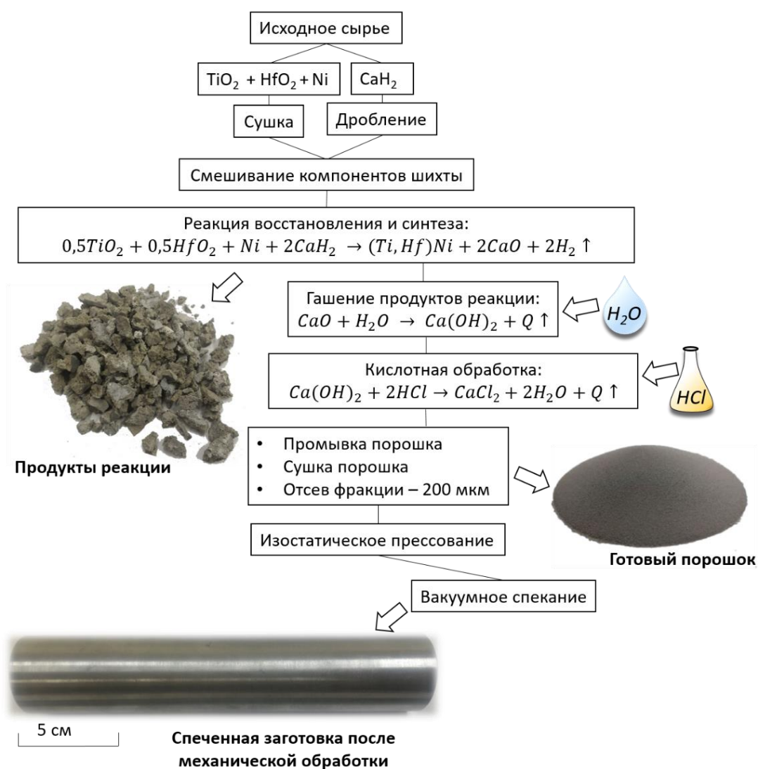
Рисунок 1 – Технологическая схема получения заготовки из интерметаллида (Ti,Hf)Ni
